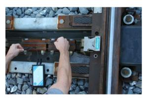
Das Gerät eignet sich auch zur Prüfung von diversen Isolierungsarten z.B. von Weichengestängen, Stellstangen u.s.w.
