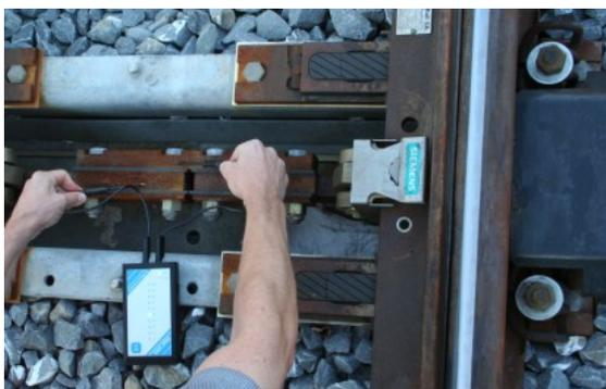
Des câbles de mesure destinés au contrôle de toute sorte d'isolation peuvent être raccordés à des douilles de mesurages supplémentaires ; comme par ex. barre d'aiguillage, barre de connexion etc.
